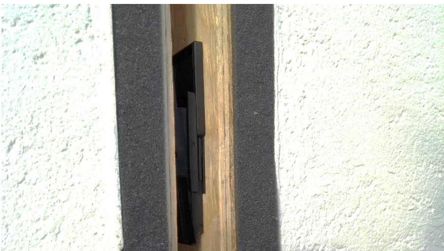
Abbildung 5: Verkeilung mittig zwischen zwei Fassadentestelementen, Sicht von außen.
