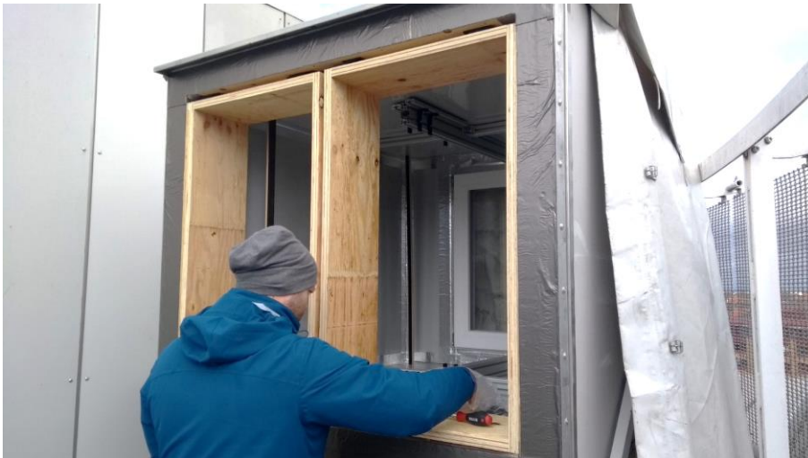
Abbildung 4: Vorbereitung und erste mechanische Tests mithilfe von Leerrahmen.
